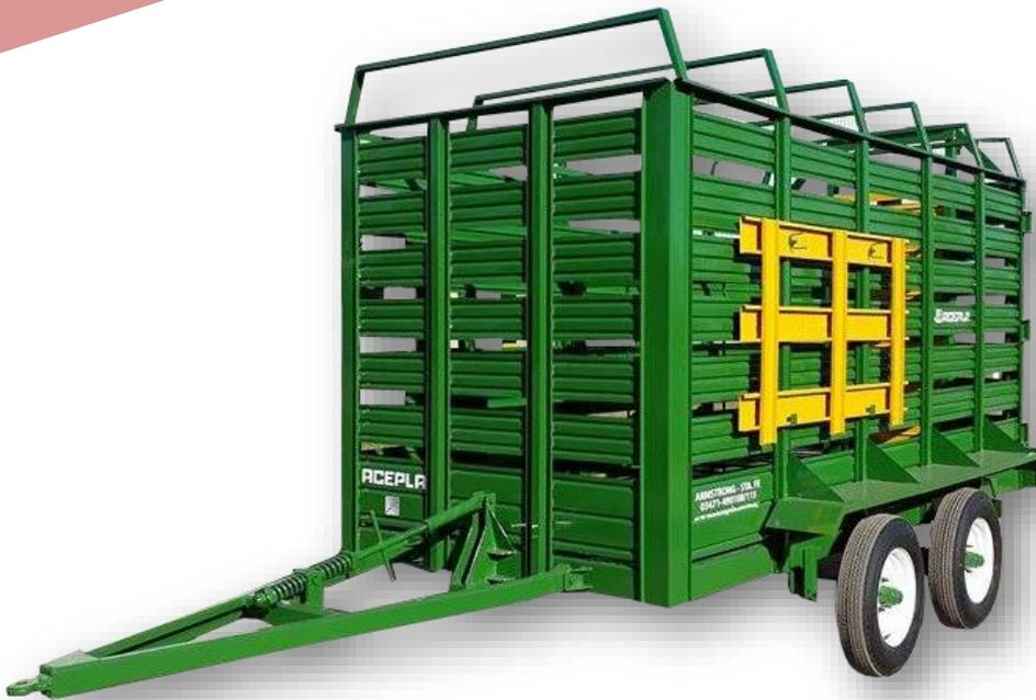
Chasis reforzado construido en chapa plegada, con transporte balancín central. Ejes 2" de acero macizo con elásticos de acero reforzado, portón trasero con guillotina y bisagras para apertura total de la misma, altura 2,2 mtrs. Rejilla para piso. Lanza fija con registro de altura de enganche. Llantas 16".
