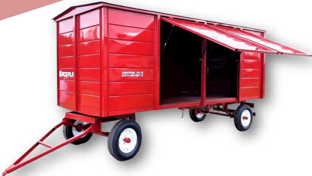
Estructura de chapa plegada, techo a dos aguas, 2 ejes, aro vantren con engrase, 4 puertas laterales levadizas con amortiguadores a gas y dos traseras tipo libro.
