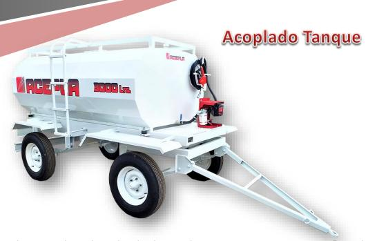
Estructura reforzada, construida en chapa plegada, elásticos de acero, aro vantren con engrase. Enganche trasero, bases para luces, barandas portaobjetos. Tanque abulonados y montados sobre tacos de goma con rompeolas, boca paso de hombre, guardabarros y paragolpes.
