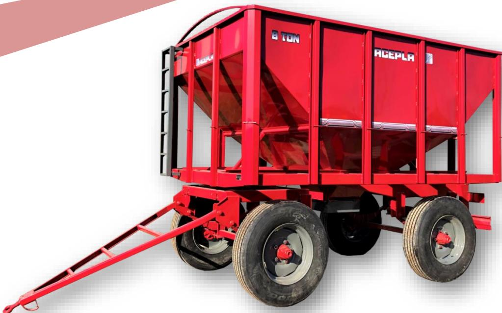
Estructura de chapa plegada, llantas 22,5" (simples o duales según modelo), pintura interior y exterior poliuretanica, ejes de acero, enganche, paragolpes, base de luces, acros.
