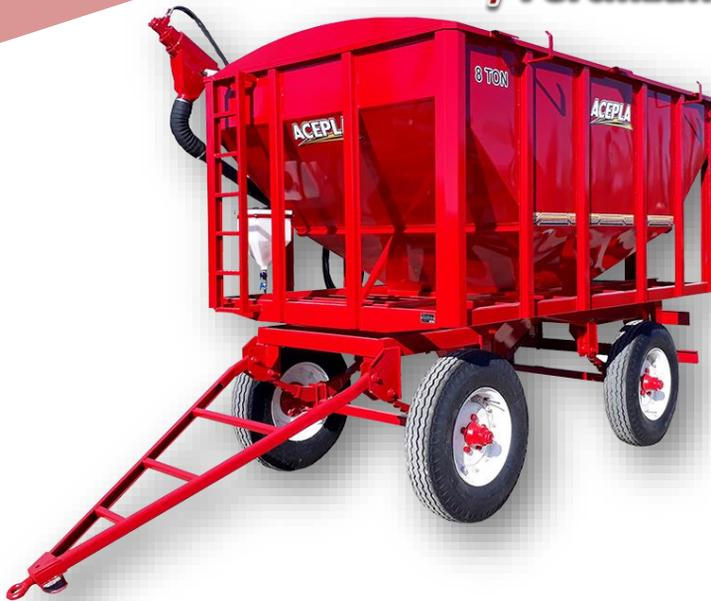
Estructura de chapa plegada, con carga y descarga por chimango de 4,5 m /5m x 160 mm, según c/modelo, accionamiento hidráulico con llave de corte, división central, llantas 22,5", pintura interior y exterior poliuretánica, ejes de acero, enganche, paragolpes, base de luces, depósito de inoculante.
