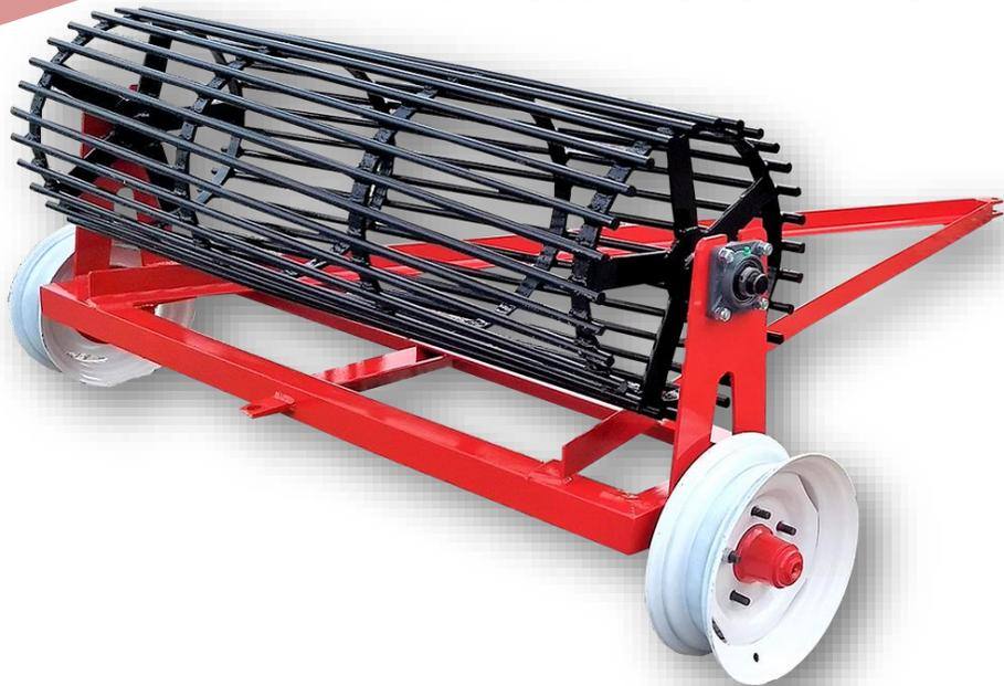
Chasis de ángulos 2 1/2". Cuerpos de 50 cm de diámetro de en hierro de 3/4", montados sobre rodamientos 05/07. Opción de incorporarle ruedas 13" para el transporte. Modelos desde 4,50 mtrs en tres cuerpos hasta 9 mtrs en 5 cuerpos.
