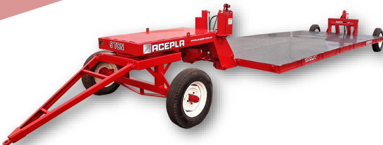
Chasis construido en UPN reforzado con tensores de 1". Puntas de ejes cambiables. Plataforma recta con chapa antideslizante. Equipo hidráulico con bomba de accionamiento manual o con tractor. Medidas de plataforma estándar 6 x 2,5 mtrs. Llantas duales 16".
